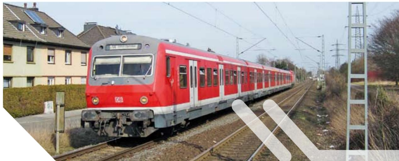
Blick vom Hp Do-Knappschaftskrankenhaus in Richtung Do-Brackel (km 31,0). Während auf diesem Teilstück in Richtung b nach aktuellem VzG nun Geschwindigkeiten bis 120 km/h möglich sind, so befindet sich die S4 in Richtung Dortmund im Bereich der dauerhaften Langsamfahrstelle mit 80 km/h
