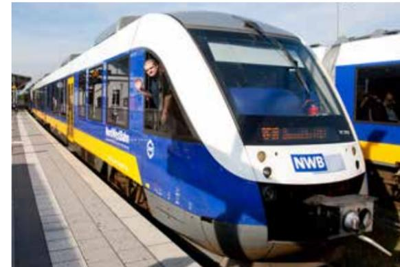
Dieseltriebwagen der Baureihe 648
