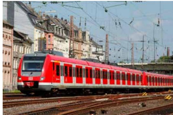
Elektrotriebwagen für S-Bahn der Baureihe 422
